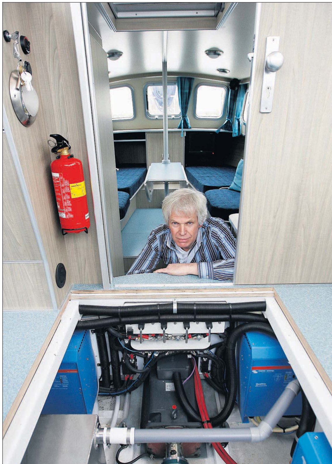
Teus Smits bij de elektromotor die rechtstreeks stroom krijgt van een generator. Foto's LC/Catrinus van der Veen
